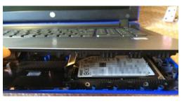
こんな感じの狭いスペースでHDDを外し、 SSDを換装(大変な作業だった)が、何とか完
