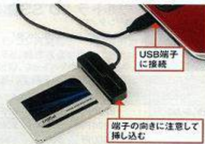
◎ 図10 7年前のノートパソコンが搭載する750ギガのHDDを「クルーシャル MX500 1テラ」(マイクロン)に交換する例で作業手順を紹介しよう
