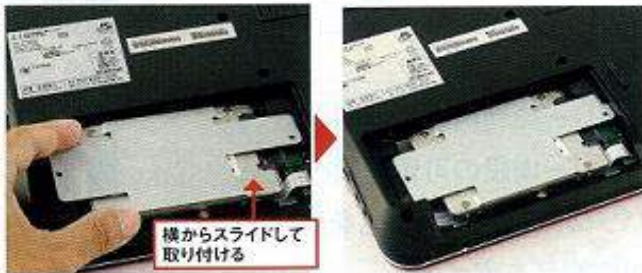
図20 SSDを取り付けた器具をパソコンに戻す。横にスライドしてSSDの端子を挿し込み、きちんと固定されたらねじ留める。あとは取り外した蓋やバッテリーなどを元に戻せばよい。SSDにはOSがコピーされているので、電源を入れれば今までと同じWindowsがより高速に起動する
