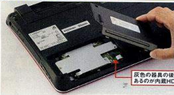
④ 図3 HDD交換が可能な機種はパソコンの底面や側面に蓋がある。その蓋を外し、HDDが簡単に取り外せる構造が確認しよう。SSDはHDDと同じ形状なので、取り外せるなら交換が可能
