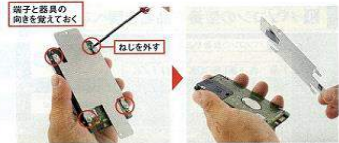
図18 4本のねじを回してHDDに固定されている器具を取り外す。後でSSDを取り付けるときに戸惑わないように、HDDの端子の向きと器具の向きを覚えておく
