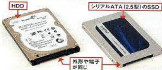
④ 図5 パソコン用のSSDは形状や端子の違いから3種類あるが、HDDの交換用として利用できるのは、HDDと外形や端子が同じシリアルATA(2.5型)の製品だ
