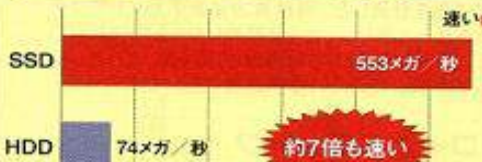
④ 図1 パソコン内蔵のデータ記録装置をHDDからSSDに交換すると、動作速度が劇的に速くなる。ウィンドウズやアプリの起動、ファイルの操作など、データの読み書き作業全般を一挙に高速化する特効薬といえる
