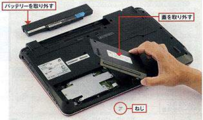
図16 「Shift」キーを押しながらシャットダウンして完全に電源オフにする。電源ケーブルやバッテリーを取り外してうっかり電源が入らないようにしたら、底面の蓋を取り外す。作業中にねじをなくさないように注意しよう
